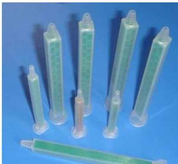
静态混合器的混合过程是由一系列安装在空心管道中的不同规格的混合单元进行的。由于混合单元的作用，使流体时而左旋，时而右转旋，不断改变流动混合机方向，不仅将中心流体推向周边，而且将周边流体推向中心，从而造成良好的径向混合效果。与此同时，流体自身的旋转作用在相邻组件连接处的接口上亦会发生，这种完善的径向环流混合作用，使物料获得混合均匀的目的。静态混合器是一种没有运动的\*\*\*混合设备，通过固定在管内的混合单元内件，使二股或多股流体产生切割、剪切、旋转和重新混合，达到流体之间良好分散和充分混合的目的。
